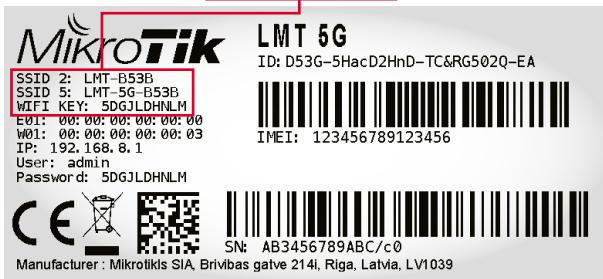
**4.2.** Datorā, planšetē vai viedtālrunī meklē savu rūtera rūpnicā doto Wi-Fi tīkla nosaukumu, piemēram, **LMT-B53B**. Rūteris strādā gan 2,4 GHz, gan 5 GHz Wi-Fi frekvencē. Būtu ieteicams izmantot 5 GHz, jo konkrētajā Wi-Fi frekvencē būs mazāk lietotāju un interferenču, tāpēc dati tiks pārraidīti ātrāk. Īpaši aktuāli tas ir daudzdzīvokļu ēkas un ofisos, kur ir ļoti noslogota 2,4 GHz frekvence. 5 GHz Wi-Fi tīkla nosaukums ir redzams uz uzlīmes, konkrētajā gadījumā tas ir **LMT-5G-B53B**.
